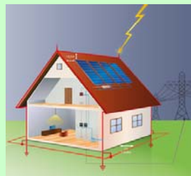
Äußerer Blitzschutz (Blitzschutzanlage)
