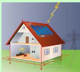
Äußerer Blitzschutz (Blitzschutzanlage)
